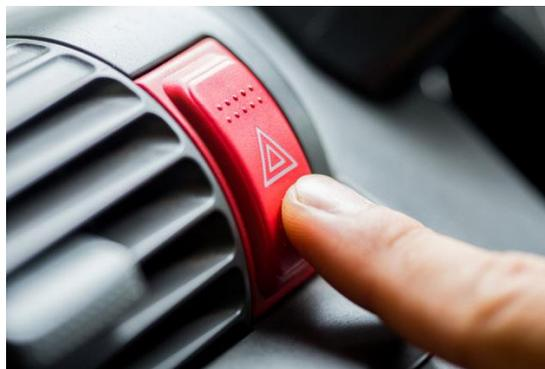
Включается эта сигнализация с помощью кнопки, расположенной на передней панели в салоне автомобиля, чаще всего на ней изображён красный треугольник.
